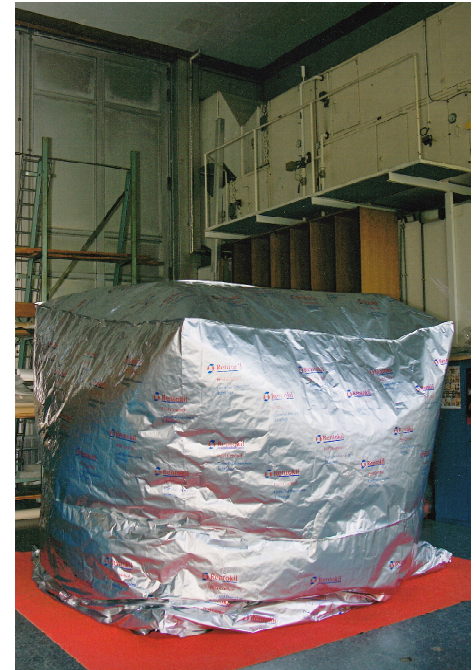
Figura 2 - Tratamento com anóxia. ©Irpa cliché n°X028244
