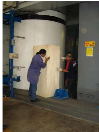
Figura 7 – Obra sendo colocada no irradiador multi proposito do IPEN.
