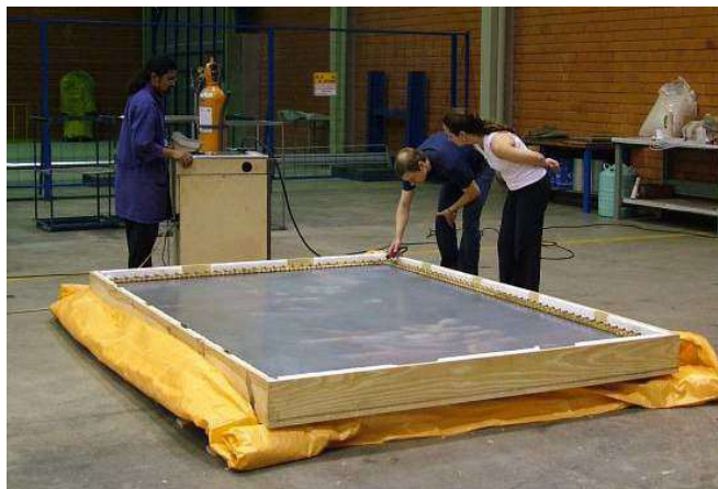
Figura 3 – Checando o vazamento da caixa de acrílico com a injeção de gás hélio e o uso de um detector Sniffer (espectrômetro de massa).
