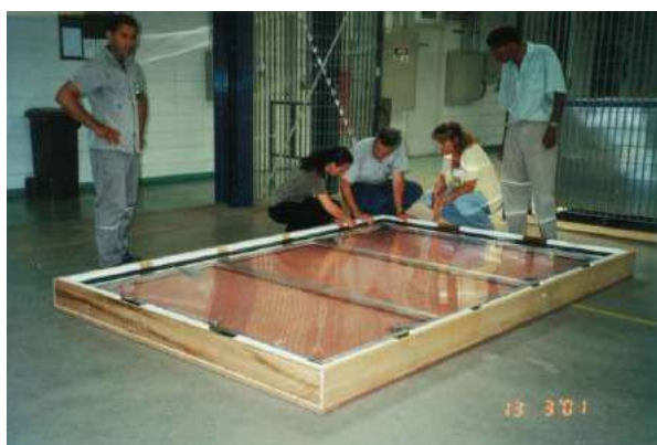
Figura 2 – Lado de trás da pintura com a proteção de acrílico dentro da caixa de madeira forrada com isopor, sendo observada antes da primeira irradiação.
