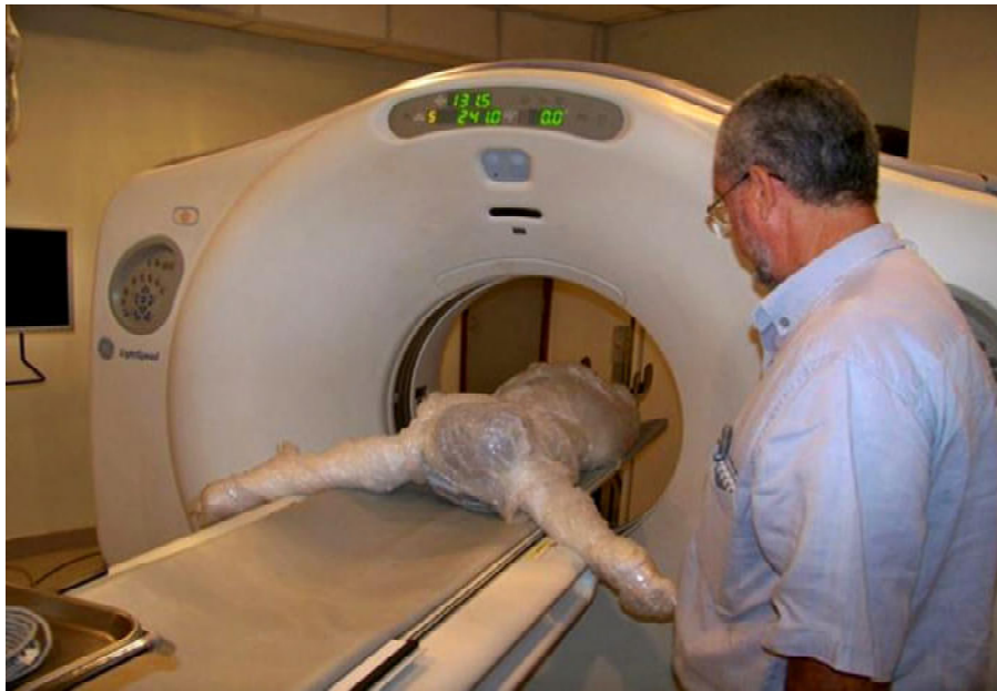
Figura 2 – Aparelho de Tomografia Computadorizada (Modelo CT-LAIT SPEEC – PRO 16 canais /GE, digitais), utilizado em exames realizados na estátua na Clínica Delfim Fonte: Marcos Lima (21/11/2009).
