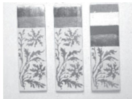
FIGURA 4 – Placas do grupo 5: esgrafito branco e acabamento com veladura mate (cola+caulim+hematita).
