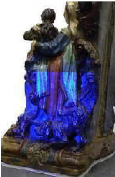
Figura 1 - Mapeamento de superfície por luz estruturada.
