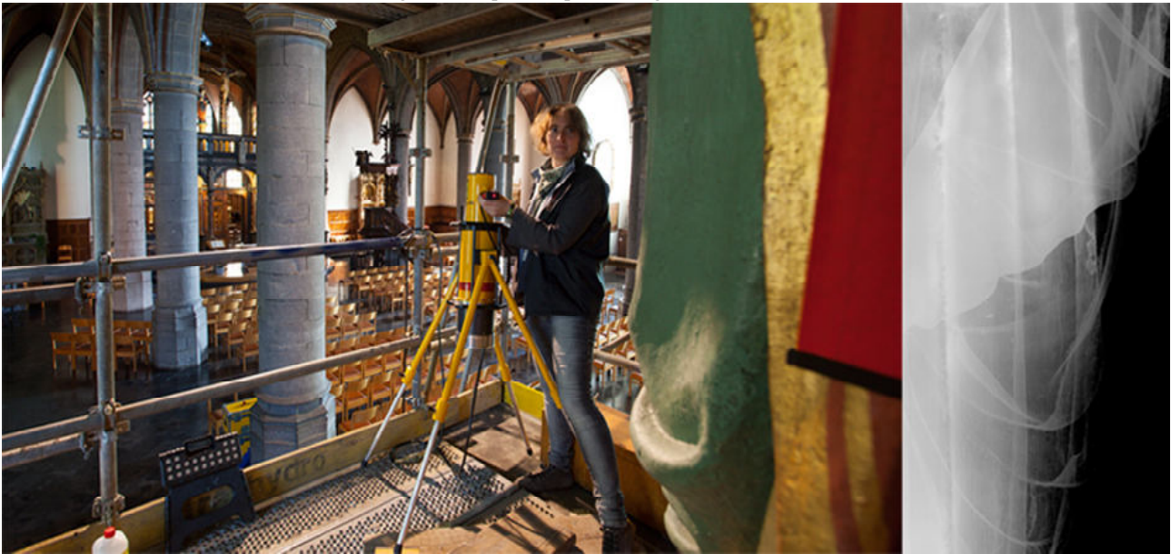
Figura 5: Preparação para radiografia no local.
