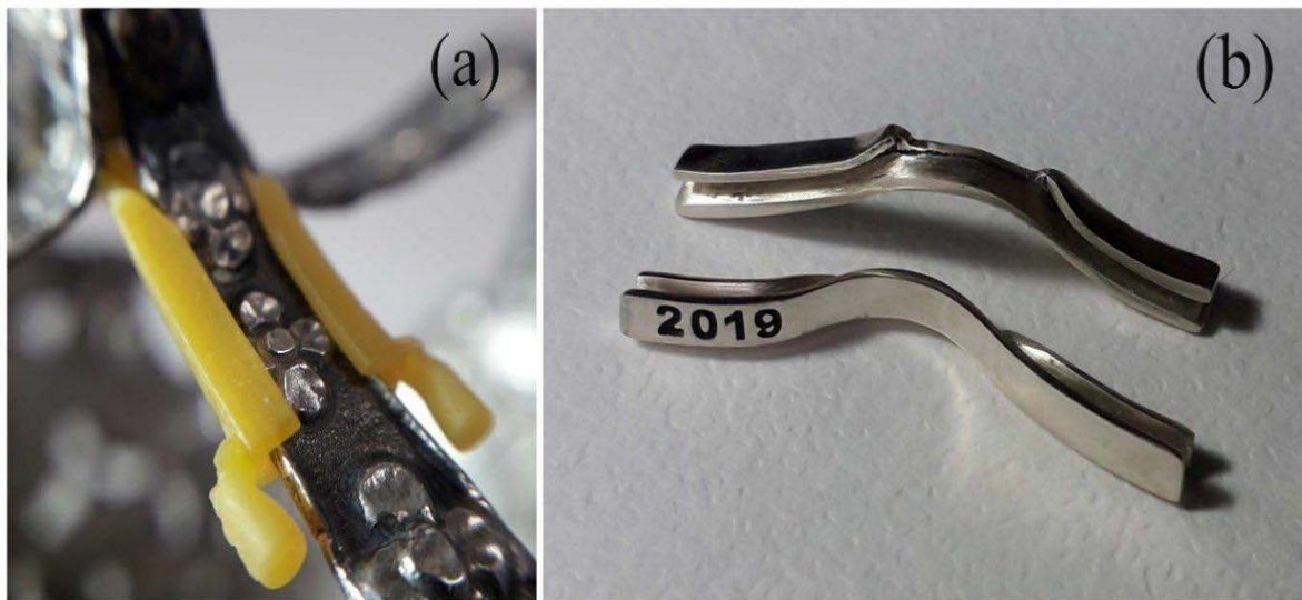
Figura 4 – Duas peças de encaixe prototipadas para a coroa Museu Mineiro em resina (a) e em prata (b).
