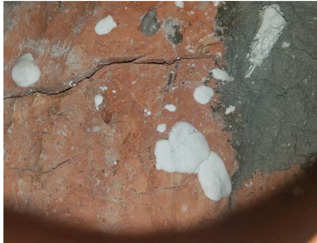
Figura 4 – Presença de argamassa e gesso na parte interna da peça.
