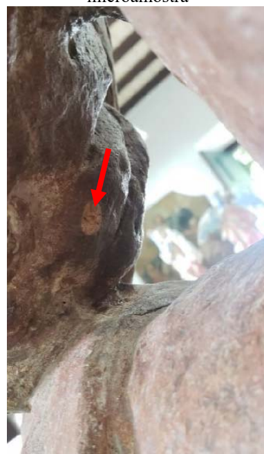
Figura 6 – Detalhe de área de fratura, com perda de material cerâmico, em que foi coletada uma microamostra
