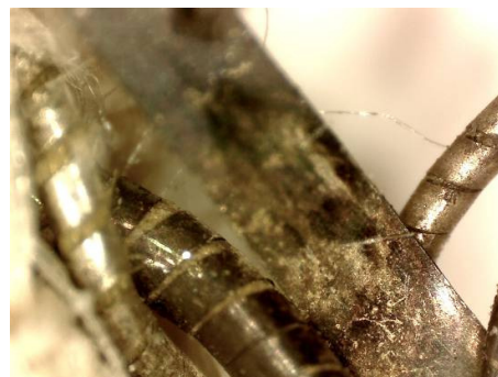
Fotomicrografia de fios metálicos (lâmina e fio metálico com alma de seda amarela). Foto: Amanda Cordeiro.
