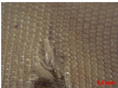
Fotomicrografia da superfície da almofada para caracterizar ligamento tafetá (canelado). Fonte: LACICOR/CECOR.
