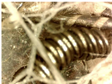
Fotomicrografia de fio metálico (canutillo) da superfície do pano da pureza. Foto: Amanda Cordeiro.
