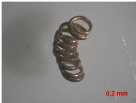
Fotomicrografia de fio metálico (canutillo) da superfície do pano da pureza. Fonte: LACICOR/CECOR.
