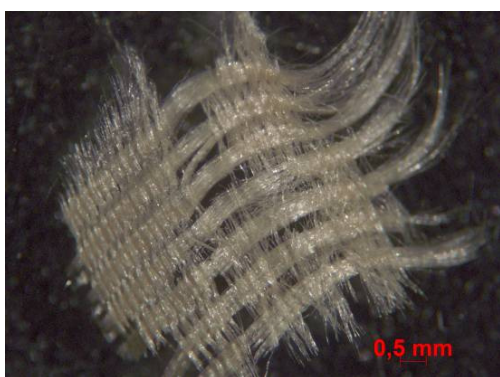
Fotomicrografia de fragmento de tecido do pano da pureza. Vista do padrão variação de tafetá e canelado. Fonte: LACICOR/CECOR
