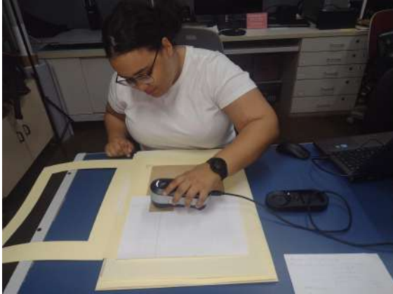
Figura 49-A - Medições de colorimetria feitas na obra "Paisagem de Ouro Preto", de 1956.
