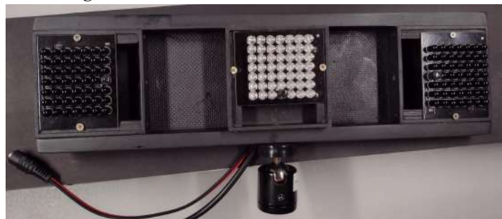
Figura 24-B - Fonte de luz Infravermelha 940nm.
