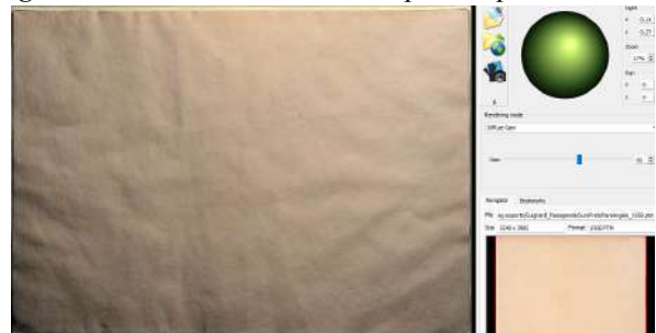
Figura 39-B - Filtro Diffuse Gain no software RTIViewer para visualização de arquivo RTI, da obra "Paisagem de Ouro Preto - Para Ângela" (1958), com o gain em 60% e a fonte de luz na parte superior central.
