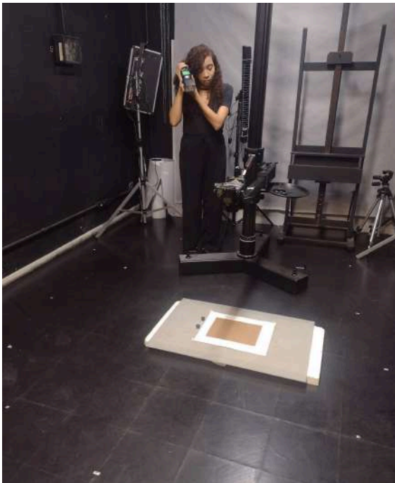
Figura 34-C - Posicionamento do flash na altura dos olhos, formando aproximadamente 49^\circ com a obra.
