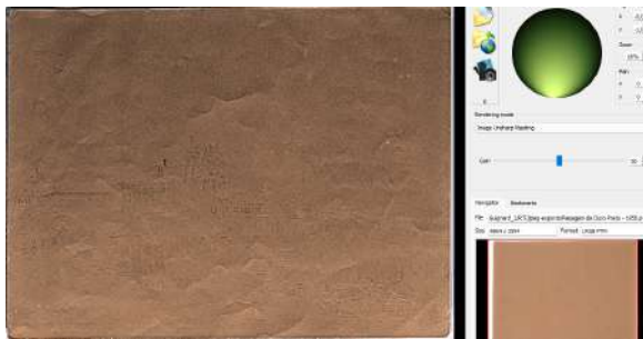
Figura 42-A - Filtro Image Unsharp Masking no software RTIViewer para visualização de arquivo RTI, da obra “Paisagem de Ouro Preto” (1956), com o gain em 50%, e a fonte de luz posicionada na parte inferior.
