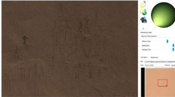
Figura 40-A - Filtro Specular Enhancement no software RTIViewer para visualização de arquivo RTI, da obra "Paisagem de Ouro Preto" (1956), com diffuse color em 50%, specularity em 70%, highlight size em 104% e a fonte de luz no centro da obra.
