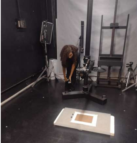
Figura 34-A - Posicionamento do flash na altura do meio da canela, formando aproximadamente 15^\circ com a obra.
