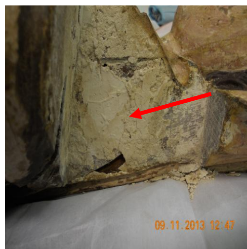
FIGURA 56 - Massa de consolidação utilizada na fixação do bloco. Foto: R.H.Gonçalves
