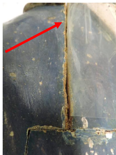
FIGURA 68 - Uso de interface de filme de poliéster (Melinex®), para espaçamento entre os blocos. Foto: R.H.Gonçalves
