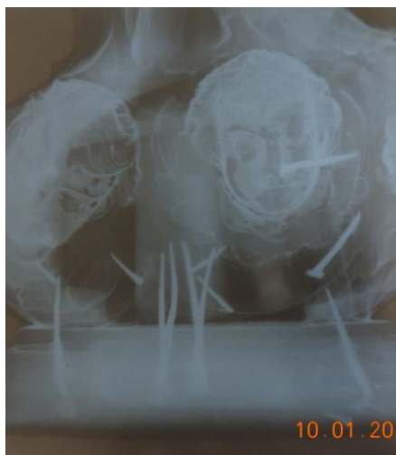
FIGURA 17 - Pregos e cravos de sustentação do bloco principal. Radiografia: Alexandre Leão Foto: R.H.Gonçalves
