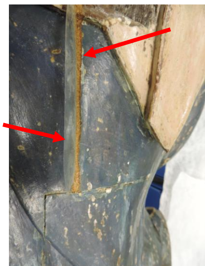
FIGURA 52 – Detalhe da consolidação e do uso do Melinex®. Foto: R.H.Gonçalves
