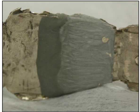
Figura 32 – Durepóxi® aplicado à Haste nº 1 desbastada e com complemento
