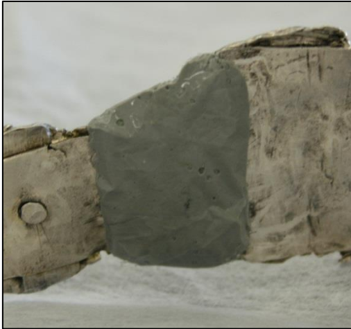
Figura 31 – Durepóxi® aplicado à haste nº 1 após secagem
