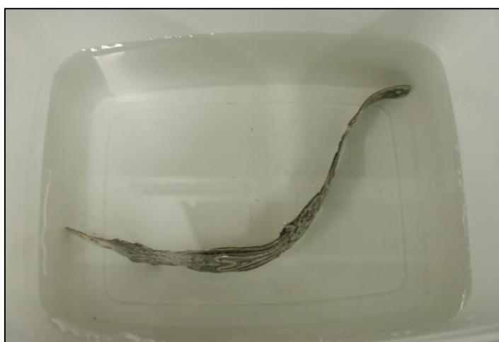
Figura 19 – Haste nº 1 em imersão na solução de tiouréia.
