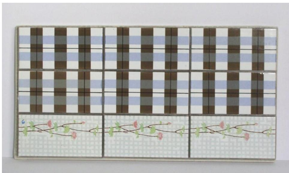
Figura 37: Painel montado após o tempo de cura do silicone
