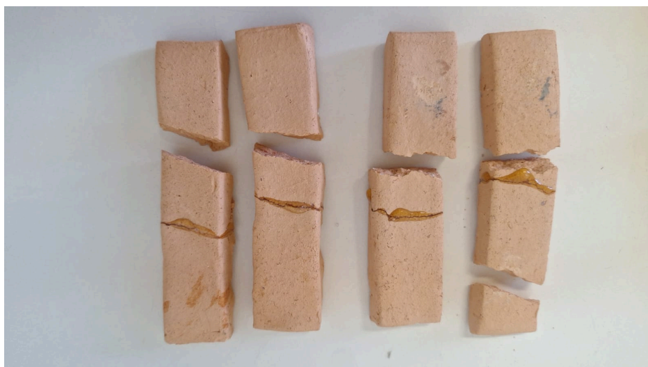
Figura 22: Adesivo epóxi na fratura da cerâmica após o teste de resistência à tração (esquerda não envelhecido e direita envelhecido).
