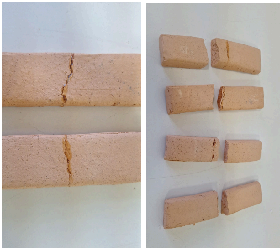
Figura 23: Adesivo Paraloid B72 (20% em etanol) na fratura da cerâmica (esquerda) e após o teste de resistência à tração (direita).
