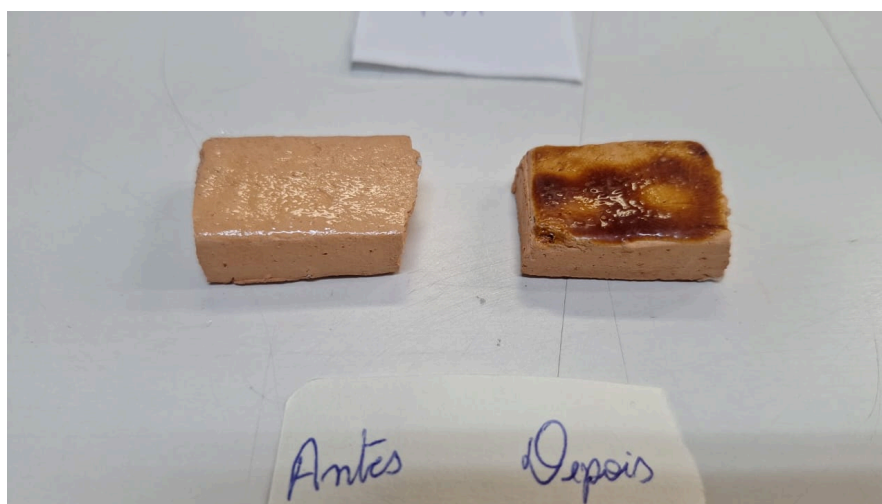
Figura 25: Adesivo PVA na superfície da cerâmica antes (esquerda) e após (direita) envelhecimento acelerado a 80 °C e 75% de umidade relativa por 7 dias.
