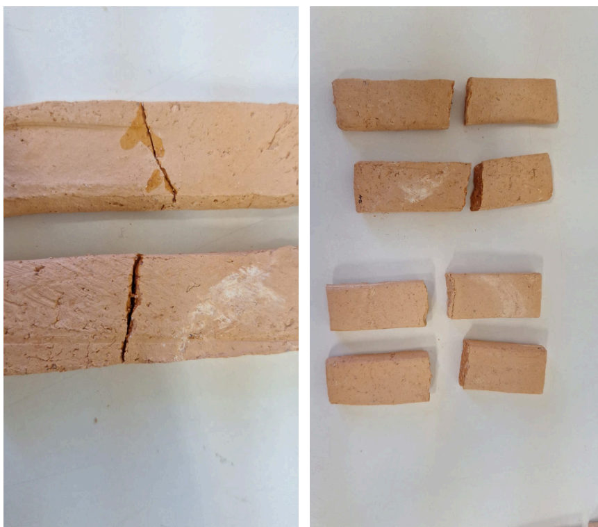
Figura 23: Adesivo Paraloid B72 (20% em acetona) na fratura da cerâmica (esquerda) e após o teste de resistência à tração (direita).
