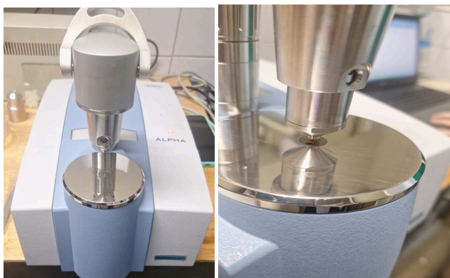
Figura 16: Equipamento de FTIR com acessório de ATR (esquerda) e amostra sendo analisada (direita).
