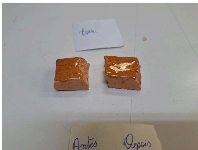
Figura 27: Adesivo epóxi na superfície da cerâmica antes (esquerda) e após (direita) envelhecimento acelerado a 80 °C e 75% de umidade relativa por 7 dias.
