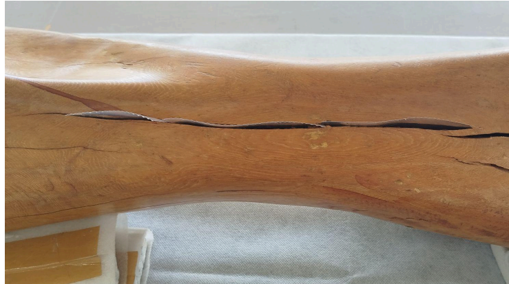
Figura 14: Junta de dilatação realizado com filme de poliéster
