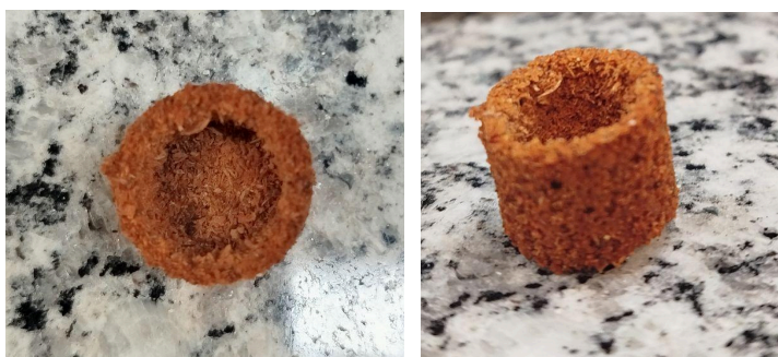
Figura 12: Corpo de prova Paraloid B72 mais serragem
