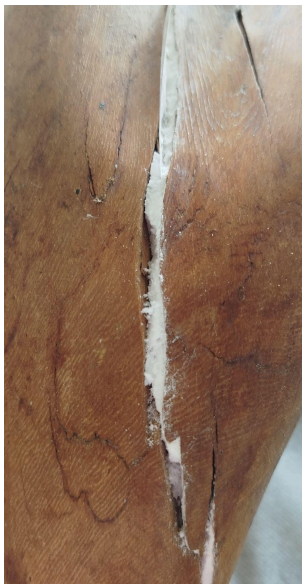
Figura 15: Resultado da remoção antecipada do acetato
