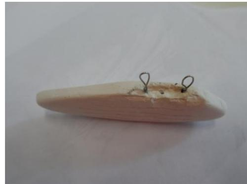
**Figura 117** Fixação dos pinos externos de aço inoxidável na asa.
