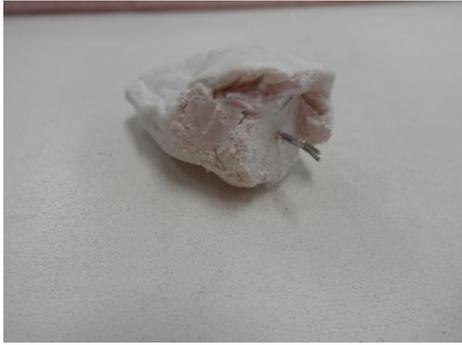
**Figura 104** Molde do dedo polegar já com a massa de gesso e o fio de aço.
