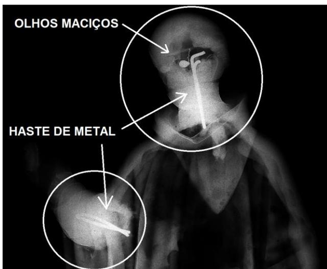
Figura 48 São Bento – RX – Detalhe da visualização dos olhos maciços e das hastes de metal da cabeça e do braço direito.
