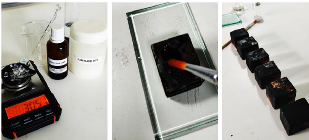
Figura 18 – Aplicação do consolidante
