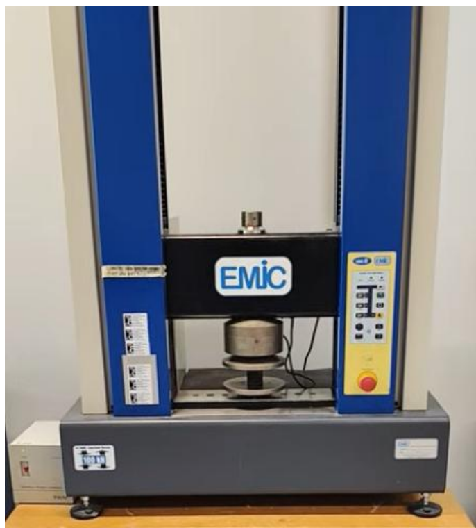
Figura 19 – Equipamento de ensaio mecânico universal EMIC DL10000
