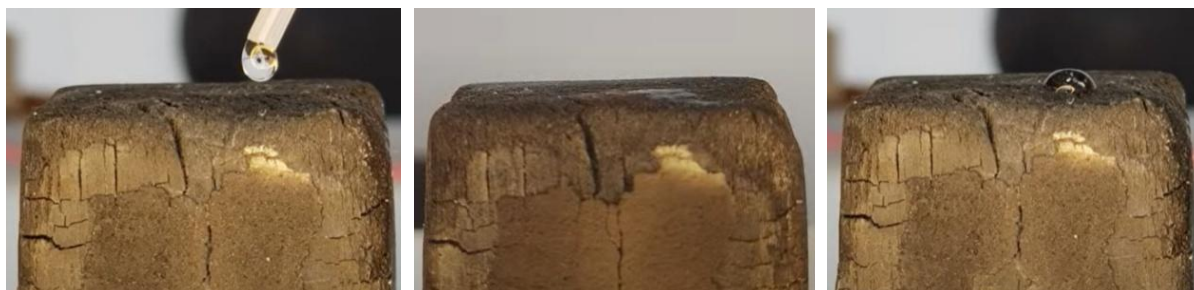
Figura 26 – Teste de molhabilidade com gotas d'água (a) aplicação; (b) antes da consolidação; (c) após aplicação de Paraloid® B-72
