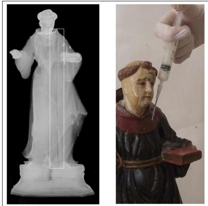
Figura 52: Consolidação com microesfera de vidro do tipo TECGLASS - TF em Paraloid® B72 a 10%, diluído em álcool etílico da galeria interna, evidenciada na radiografia. Radiografia: Alexandre Leão. Foto: Núbia Quinetti
