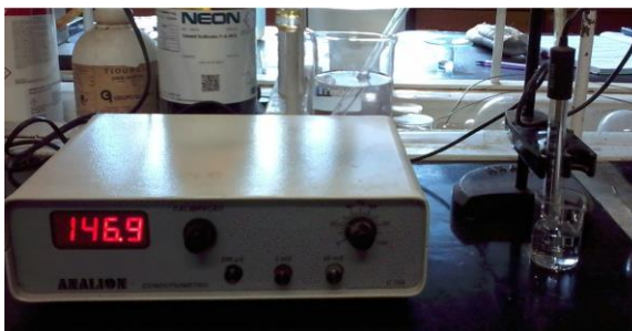
FIGURA 20: Da esquerda para direita, condutímetro calibrado e uma gota de água deionizada sobre a obra
