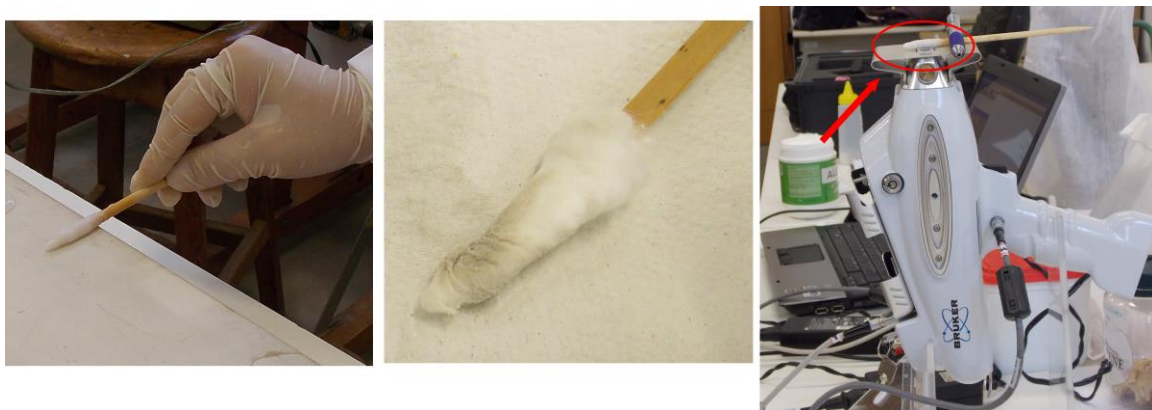
FIGURA 21: Da esquerda para direita: limpeza com a emulsão, utilizando um swob; sujidade presente no algodão após a limpeza; aparelho de fluorescência de raios-X
