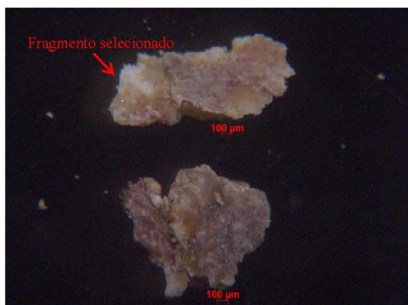
Figura 07 - AM 3060T – Vista frontal do fragmento usado para corte estratigráfico. Aumento 50x visto sob microscópio estereoscópico
