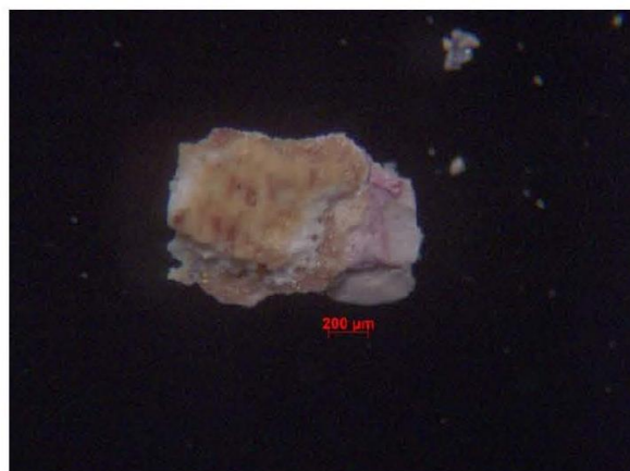
Figura 05 - AM 3059T –Vista do verso do fragmento usado para corte estratigráfico. Aumento 60x visto sob microscópio estereoscópico
