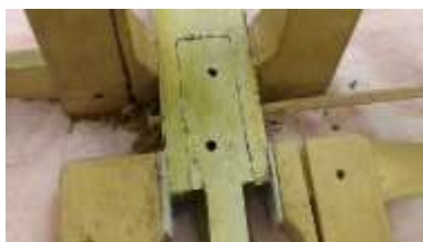
Figura 31: Detalhe colocação do pino na parte inferior vertical da cruz
