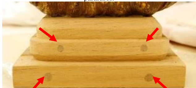
FIGURA 51 – Colocação dos tarugos nos orifícios dos parafusos.
