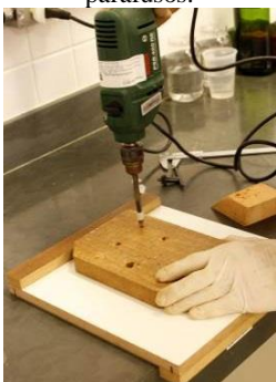
FIGURA 46 – Perfuração da base retangular para a colocação dos quatro parafusos.
