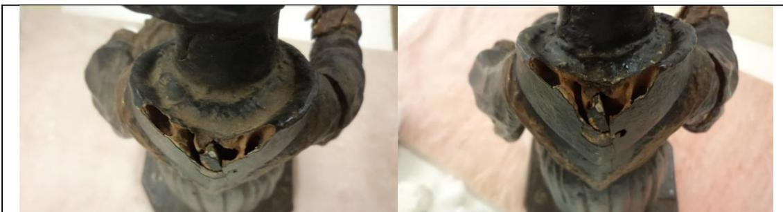
Figura 114 - Antes e depois da limpeza mecânica do capuz.
