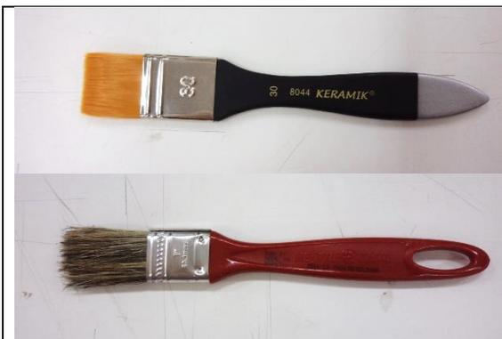
Figura 72 – Trinchas utilizadas para limpeza mecânica.
