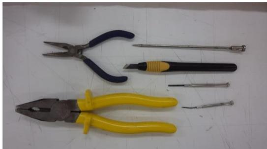
Figura 79 - Instrumentos utilizados para a remoção dos pregos.
