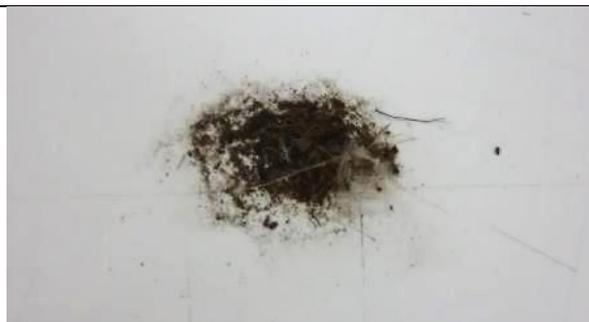
Figura 74 - Particulado removido com a limpeza mecânica.
