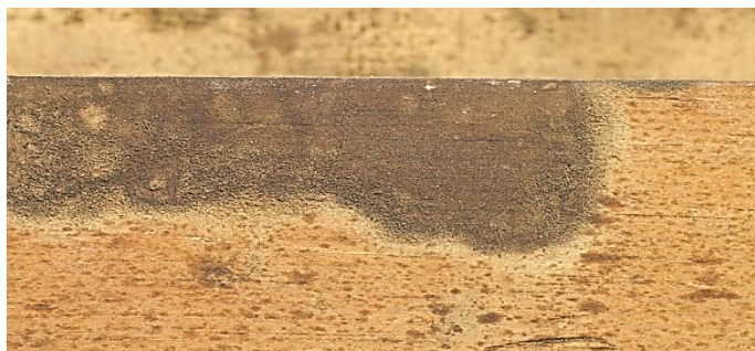
Fotografia 70- Detalhe do chassi repleto de fungos.
