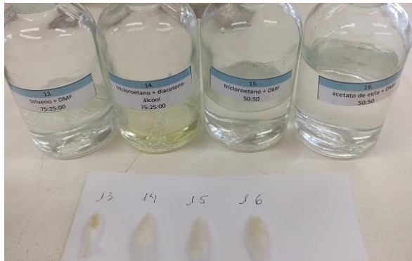
Fotografia 135- Testes com solventes.
