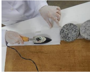
Fotografia 162- Fixação da tira de tecido na tela.
