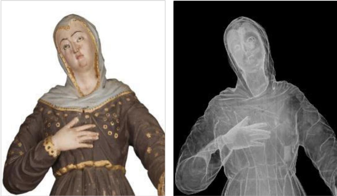
Figura 42: Comparação entre a fotografia com luz visível e a radiografia. Nota-se que as áreas que correspondem à carnação são mais esbranquiçadas, indicando presença de branco de chumbo.
