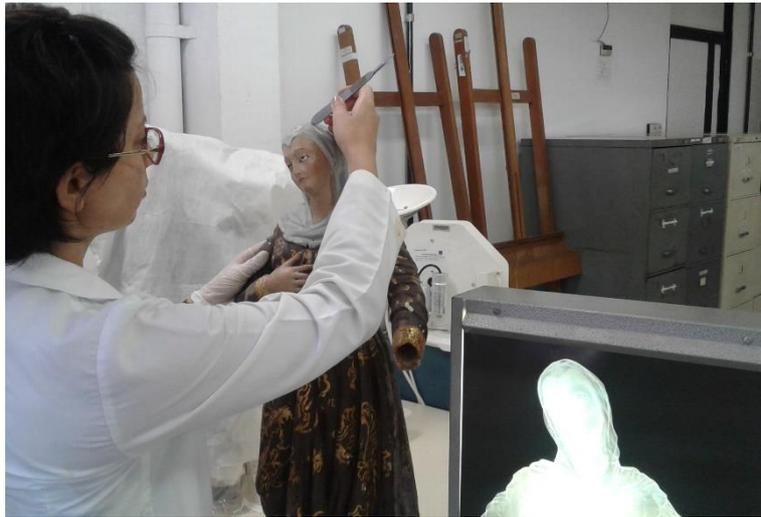
Figura 85: Localização das galerias por método de percussão junto com a radiografia.
