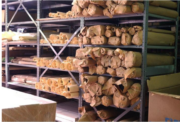
Figura 43 – Materiais empacotados nas prateleiras. Danificados pela maneira como eram enrolados
