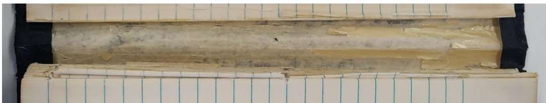
Figura 3 – Detalhe da lombada de percalina degradada Fonte: acervo da autora (2022)
