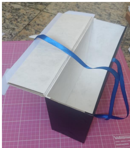
Figura 34 – Caixa durante processo de colagem do revestimento Fonte: acervo da autora (2022)
