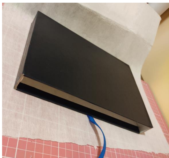
Figura 35 – Luva durante processo de colagem do revestimento Fonte: acervo da autora (2022)
