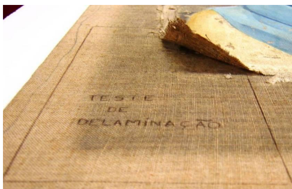
Figura 24 – Detalhe do teste de delaminação realizado na tela Fotografia: Lilian Ramos
