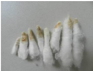
FIGURA 96- Teste com Terebentina. O algodão demonstra a ineficiência deste solvente para a remoção. Fotografia: Ana Carolina Rodrigues out/ 2013.
