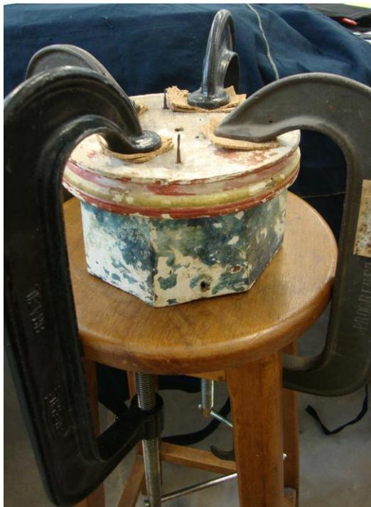
Figura 36 – Desempenamento e fixação dos sub-blocos da base. Fonte: Otávio Borges
