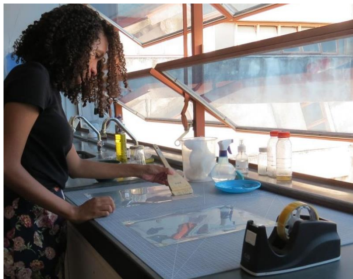
Figura 75 - Aplicação do KluGel G em poliéster 75 micras. Fonte: Fotografia da autora.
