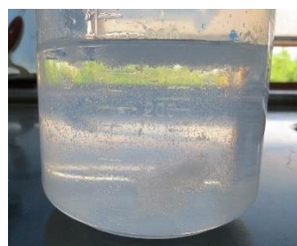
Figura 74 – Formação de grumos a partir da mistura do klucel G em água e álcool.
