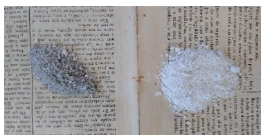
Figura 71 – Borracha ralada antes da limpeza (direita) e após (esquerda). Fonte: Fotografia da autora.
