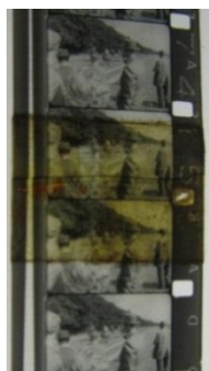
Figura 41– Oxidação do adesivo da emenda realizada com material inadequado.
