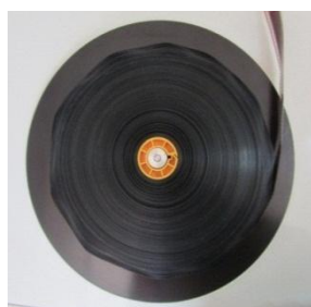
Figura 38–Abaulamento do suporte do tipo em onda
