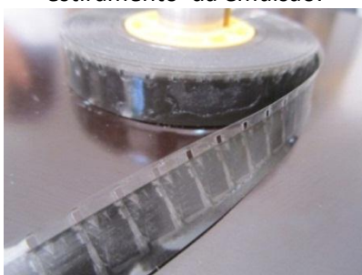
Figura 39–Cristalização no lado do suporte.
