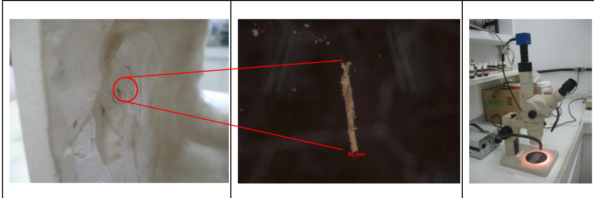
FIG. 40 a 42: Coleta de amostra da fibra e sua análise em laboratório Fonte: Vanessa Taveira
