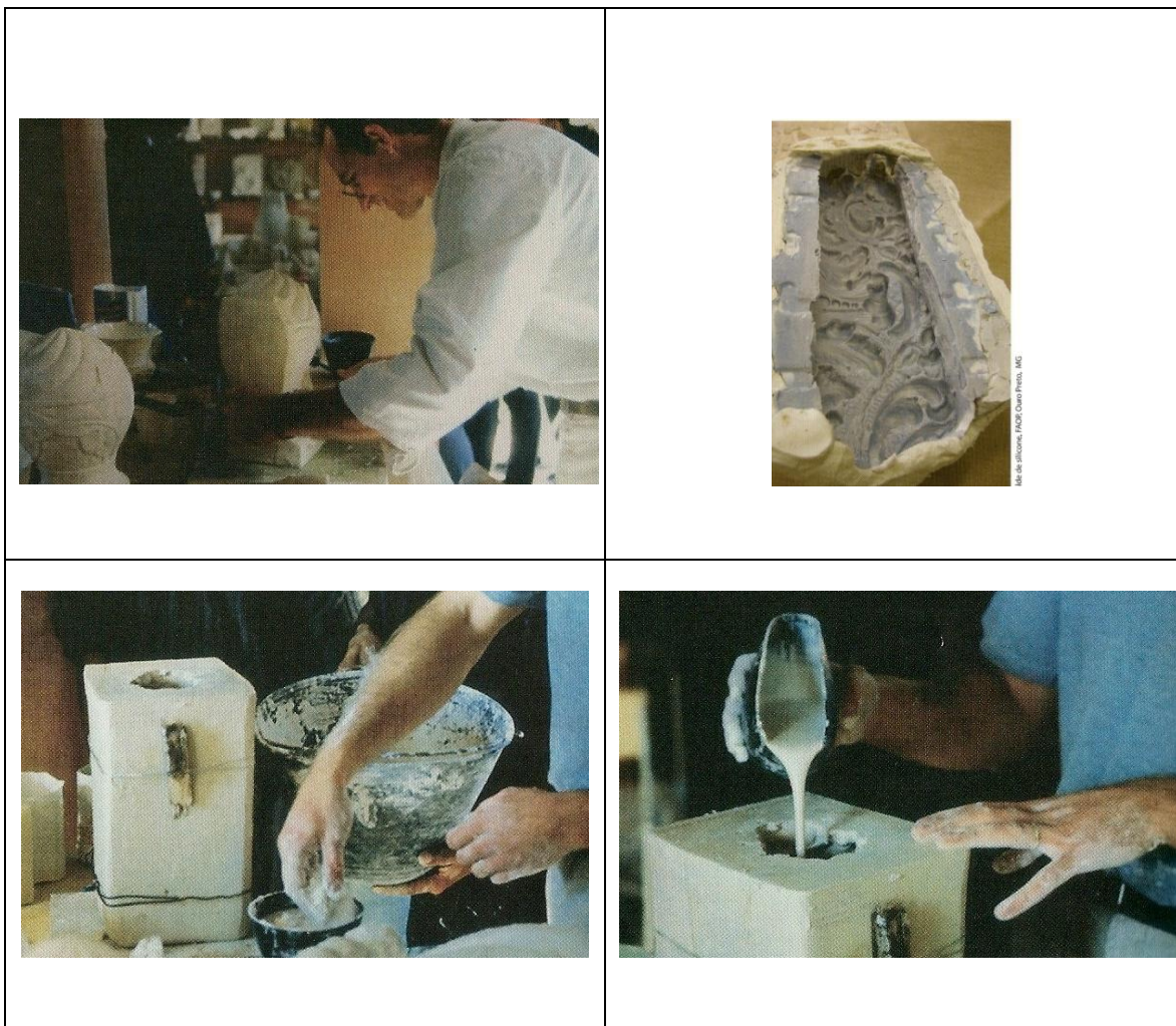
FIG. 14 a 17: Produção de estuques ornamentais e aplicação da massa de fundição Fonte: Caderno de Ofícios: Estuque. Alexandre Mascarenhas
