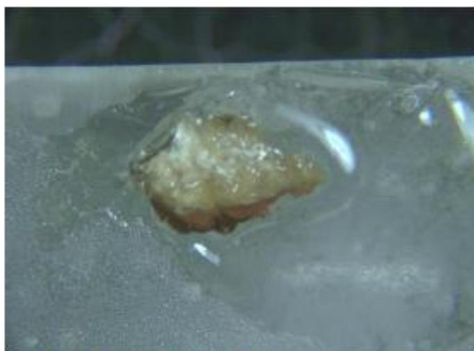
Fig 6-Am 3426T-visto sob o microscópio estereoscópico-aumento 15x-evidenciando a colagem do fragmento sobre o bloco de acrílico para montagem do corte estratigráfico
