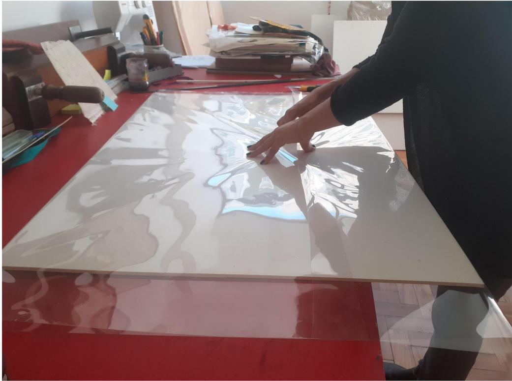
Figura 32: Fechamento da embalagem de filme de poliéster + *foam board* - fotografia do autor, 03/07-2023
