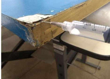
Figura 77: Aplicação de adesivo com seringa. Fonte: Fotos do autor, 2018.
