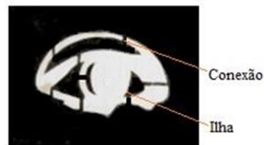
Figura 24: Conexão e Ilha representados no molde. Fonte: CARLSSON, 2015 (imagem modificada pelo autor).
