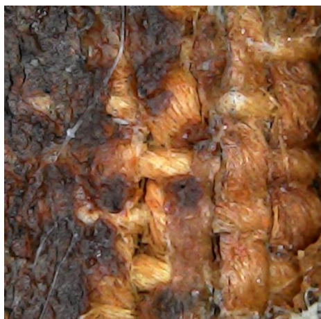
FIGURA 15 – Fotografia microscópica da trama do tecido do revestimento do canto
