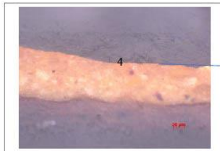
3911T-Corte estratigráfico visto sob o microscópio de luz polarizada- Detalhe da folha de ouro-aumento 66x- Referente ao fragmento 80x
