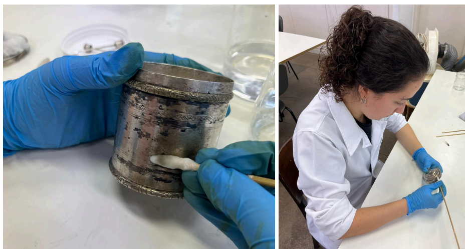
Figura 42 - Limpeza química com glicinato de sódio
