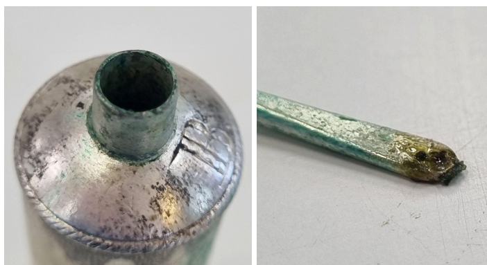
Figura 40 - Produtos de corrosão esverdeados e de aparência oleosa
