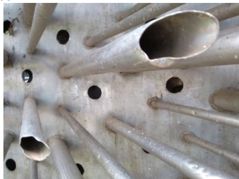
Figura 77 Amassamentos extremidades dos tubos.
