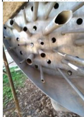
Figura 129 Após limpeza mecânica.
