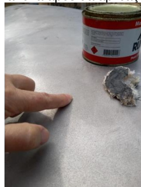
Figura 181 Mancha após da aplicação da pasta.
