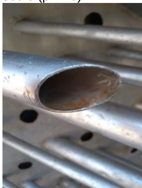
Figura 191 Antes aplicação de EDTA a 5% com hidróxido de sódio (pH 10).
