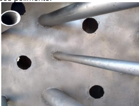
Figura 244 Detalhe da chapa após polimento.
