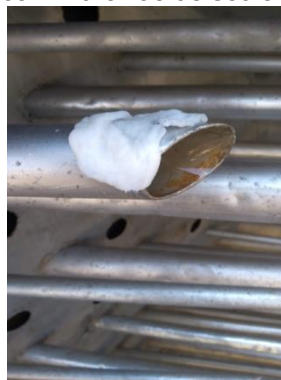
Figura 192 Após compressa de 5 minutos de EDTA a 5% com hidróxido de sódio (pH 10).
