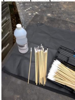
Figura 156 Acetona e swabs na remoção das pichações.
