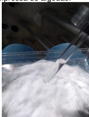
Figura 211 Solução aplicada com conta gotas sobre compressa de algodão.
