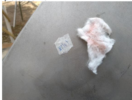
Figura 165 Migração de pigmento para a compressa de xilol.
