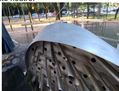
Figura 155 Cilindro após limpeza com água e detergente neutro.
