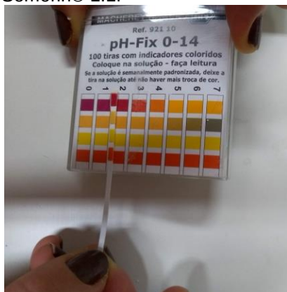
Figura 188 Teste de pH (2) Semorin® 1:1.
