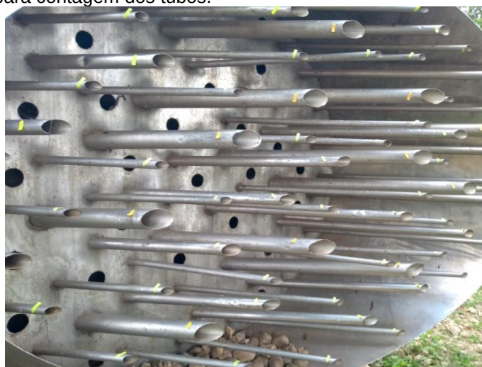
Figura 44 Marcação para contagem dos tubos.
