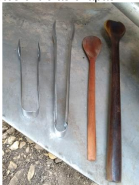
Figura 135 Instrumentos utilizados para remoção de objetos entre as chapas.
