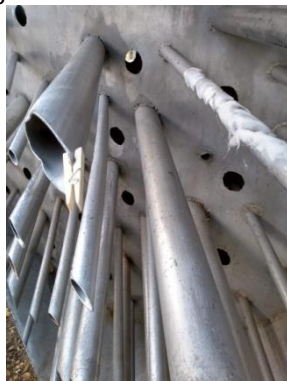
Figura 226 À esquerda, tubos já enxaguados.
