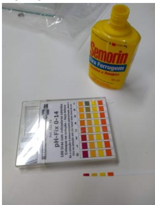
Figura 182 Teste pH (1) Semorin®.
