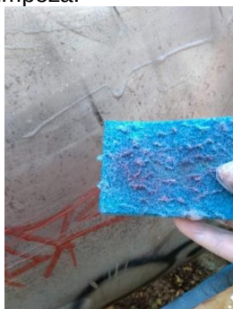
Figura 151 Tinta alquídica vermelha sensibilizada com a limpeza.
