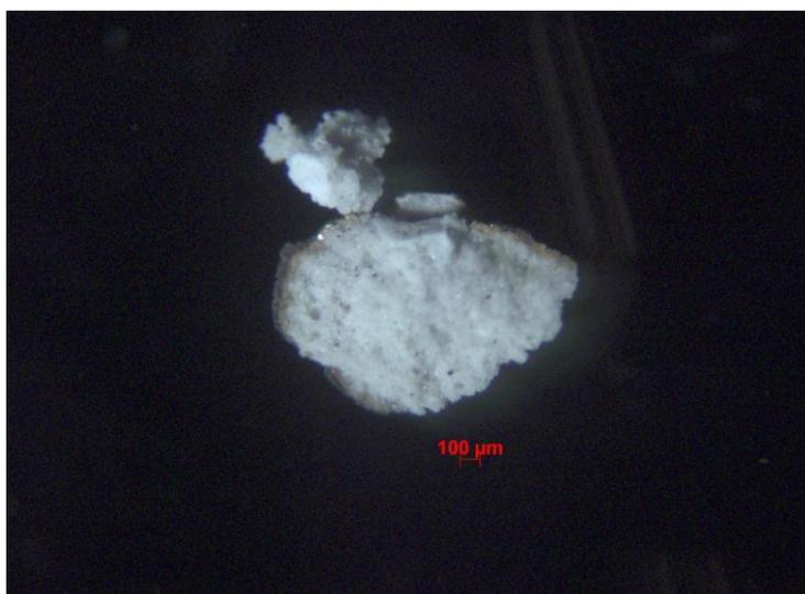
Figura 09: AM 3157 T: Verso do fragmento usado para montagem do corte estratigráfico visto sob microscópio estereoscópico Aumento 45x.
