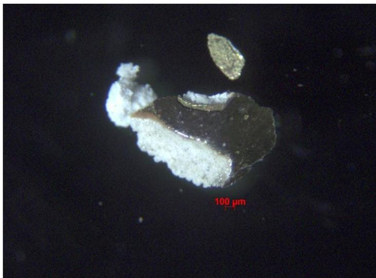
Figura 08: AM 3157 T: Frente do fragmento usado para montagem do corte estratigráfico visto sob microscópio estereoscópico Aumento 45x.
