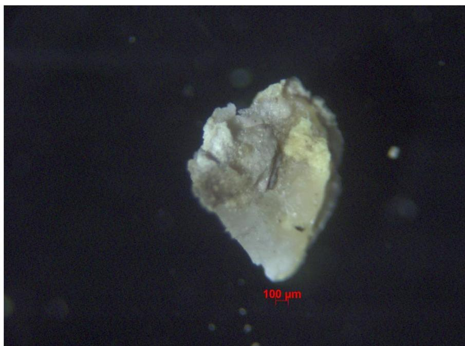
Figura 05 AM 3155T: Verso do fragmento usado para montagem do corte estratigráfico visto sob microscópio estereoscópico Aumento 50x
