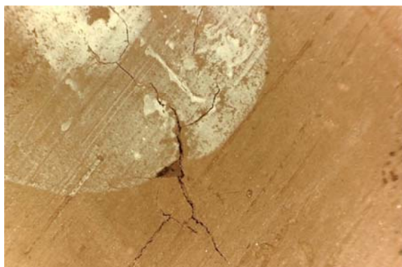
FIGURA 39 – Detalhe de microfissura sob a camada de policromia da peça. Foto realizada com microscopia USB, aumento de 60x, Agésilau Neiva Almada, 2013.
