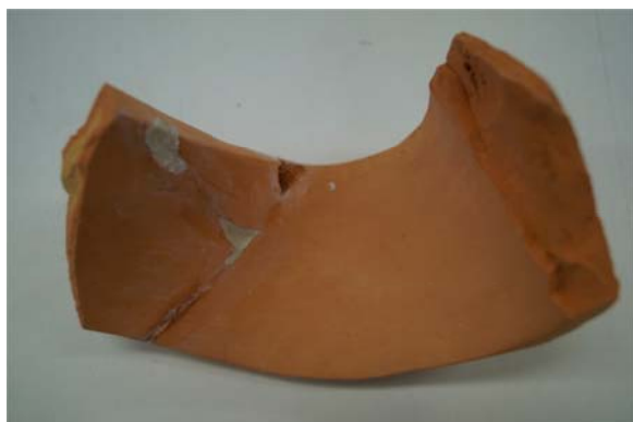
FIGURA 89 – Teste de aplicação e reversibilidade da massa de nivelamento em protótipo (frente). Foto: Agésilau Neiva Almada, 2013.
