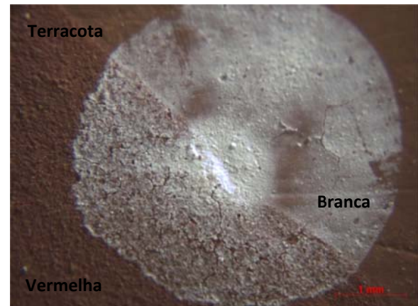
FIGURA 60 – Detalhe das camadas de policromia: A vermelha e branca apresenta mais áspera e menos estável que a terracota. Foto: Renata Novais Silva, 2013, aumento de 44x.
