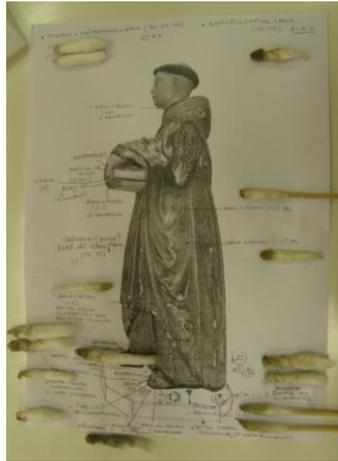
FIG. 92: mapeamento de áreas de teste de solventes
