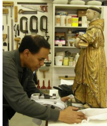
FIG. 91: exame de Fluorescência de Raio-X
