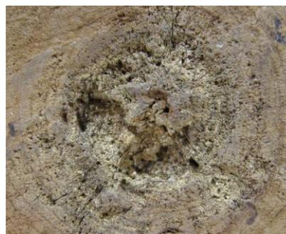
FIG. 42: degradação medula do bloco
