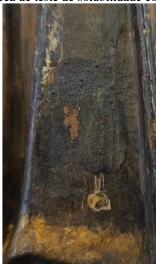
Figura 51: Área de teste de solubilidade com Álcool 70°
