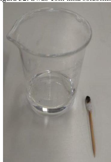
Figura 52: Swab com tinta solubilizada
