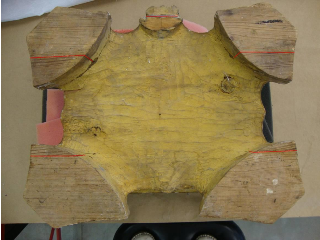
Figura 16 – Parte inferior da peanha com marcas de goiva, linhas vermelhas indicam os blocos dos pés e a junção da decoração frontal.
