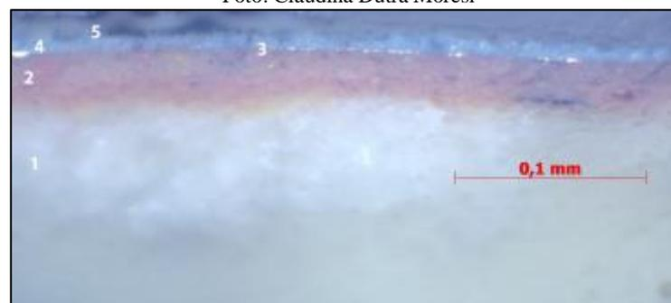
Figura 47. Imagem do mesmo corte estratigráfico da amostra 2, ao microscópio ótico com luz plano polarizada, mostrando a folha de ouro. Foto: Claudina Dutra Moresi.
