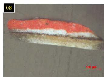
CORTE ESTRATIGRÁFICO DE POLICROMIA COM CAMADA DE DOURAMENTO E PINTURA VERMELHA.
