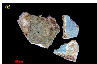
AMOSTRA DE DOURAMENTO COM ESGRAFIADO AZUL.
