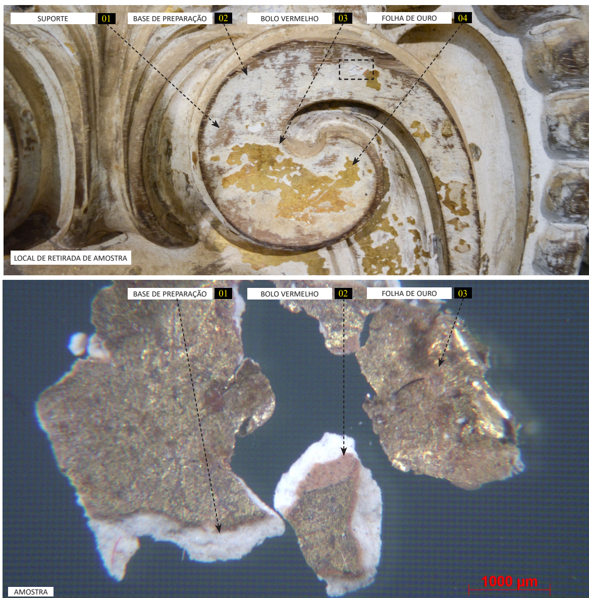
FIGURA 21 - Quadro mostrando fragmento do douramento no frontal e amostra AM 3062 T, desse douramento fotografada em microscópio estereoscópico em ampliação de 25x deixando evidente camadas visíveis do douramento. Foto: André Andrade, 2016.
