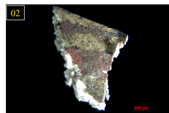
AMOSTRA DE DOURAMENTO COM CAMADA DE BASE DE PREPARAÇÃO, FOLHA DE OURO E PINTURA VERMELHA.
