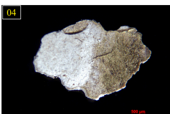
AMOSTRA DE DOURAMENTO COM CAMADAS DE REPINTURA BRANCA.
