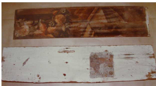
OBRA DE 1984 - REMOÇÃO DE REPINTURA BRANCA QUE RECOBRIA O FORRO PRIMITIVO. TESTE REALIZADO APÓS A DESMONTAGEM. FORRO PRIMITIVO DA CAPELA MOR FOI DESCARTADO MESMO APÓS ALERTA DOS RESTAURADORES SOBRE A PINTURA DECORATIVA.
