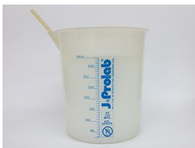
Figura 90: Mistura de 4 L de água e 4,4 g de carbonato de cálcio
