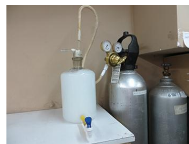
Figura 92: Frasco mariotte conectado ao cilindro de dióxido de carbono
