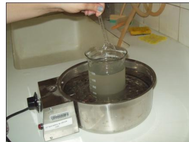
Figura 97: Aquecimento da mistura em banho-maria a 40°C
