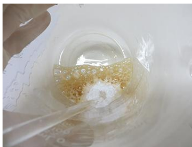
Figura 81: Adição de carbonato de cálcio em ácido fítico
