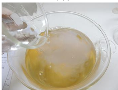
Figura 84: Adição de hidróxido de amônio à mistura
