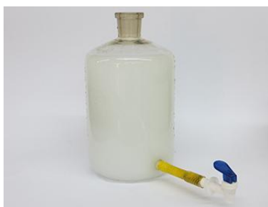
Figura 91: Mistura em um frasco mariotte
