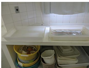
Figura 89: Banho de imersão em água deionizada e preparação do banho de bicarbonato de cálcio
