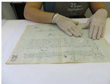
Figura 76: Aplicação de pó de borracha sobre o fólio
