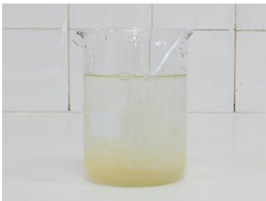
Figura 95: Mistura de 500 mL de água deionizada e 10 g de gelatina
