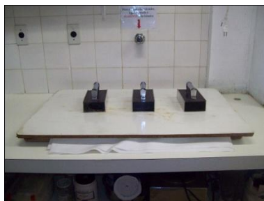
Figura 99: Documentos em sanduíche de feltro colocados sob pesos após encolagem
