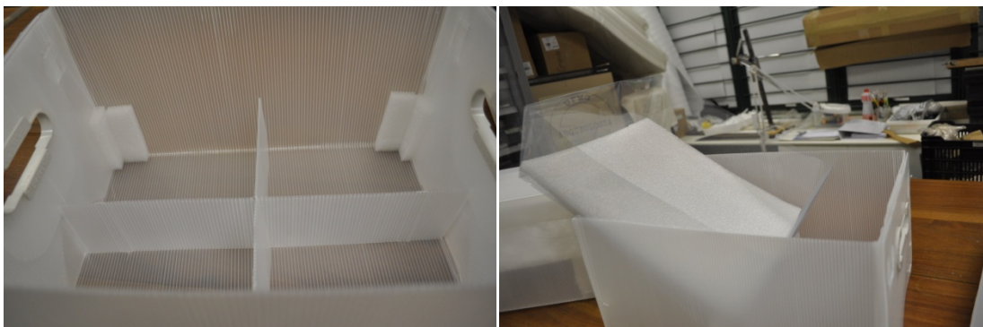
Figura 25 – Fonte: Ana Carolina Montalvão. Colméias de polionda Prateleiras, base de placa de EPE e caixa de filme de Poliéster.
