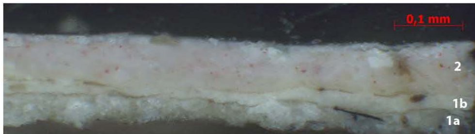
Figura 2 - Imagem do corte estratigráfico da amostra 1, ao microscópio ótico com luz plano polarizada, mostrando as seguintes camadas: 1 base de preparação branca, subdividida, 2 rosa claro.
