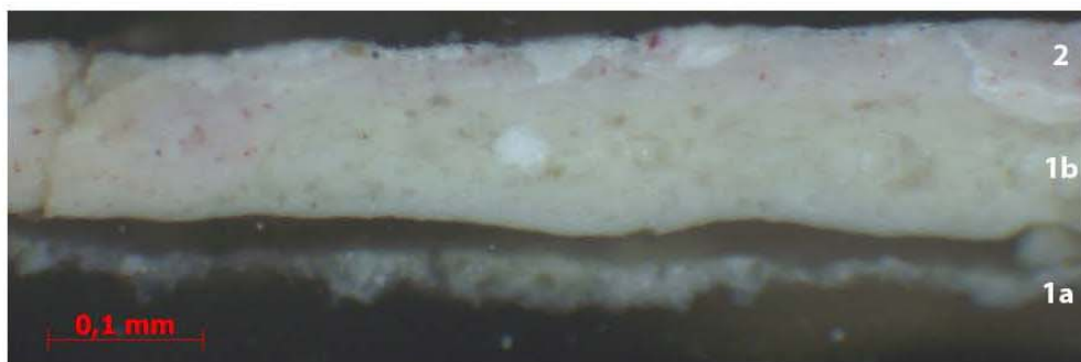
Figura 3 - Imagem do corte estratigráfico da amostra 2, ao microscópio ótico com luz plano polarizada, mostrando as seguintes camadas: 1 base de preparação branca, 2 rosa claro.
