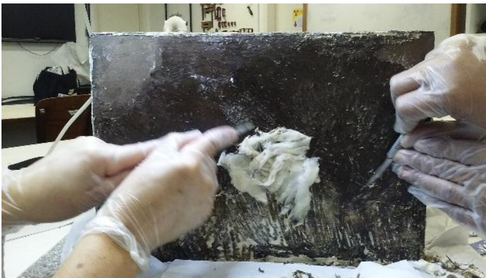
Figura 16 - .Remoção do adesivo aderido na base.
